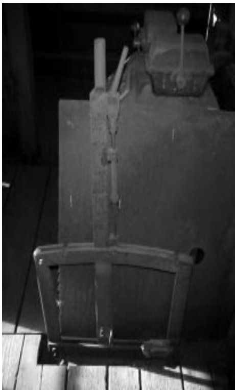
Foto 2.9.3: Schalthebel zum Schalten Einrücken/Ausdrücken
