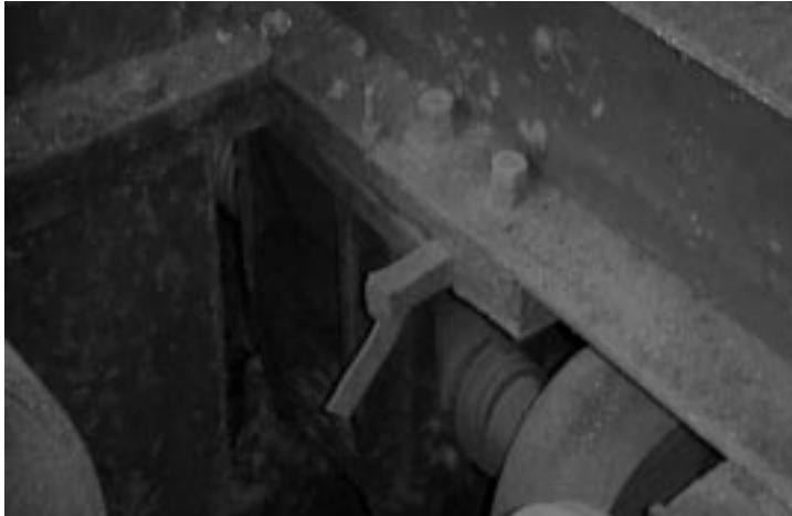
Foto 2.2.15: Detail Verkeilung Spindelmutter (hinterer Querantrieb)
