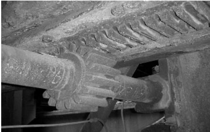
Foto 2.3.6: Antriebsritzel Türabheberwagen mit Zahnstange
