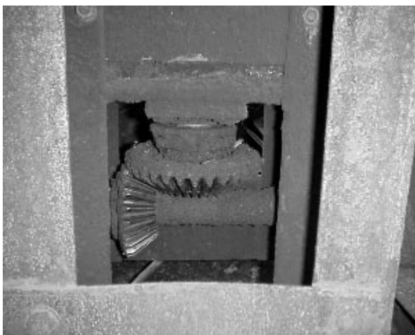
Foto 2.3.4: Kegelradgetriebe zum Ansteuern Wippe
