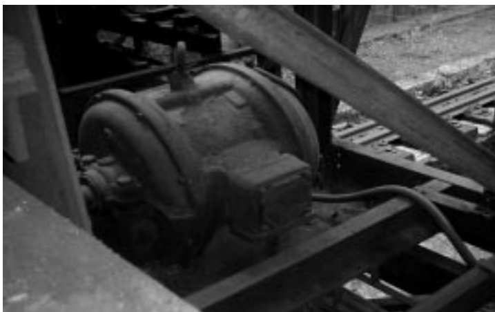
Foto 2.4.6: Antriebsmotor zum Verfahren Ausdrückstange
