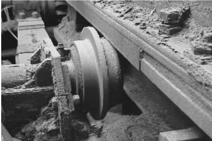
Foto 2.4.1: zweiteilige Auflagerrolle Ausdrückstange (im Hintergrund: Gleitschuh)
